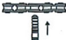
3. Com uso de uma chave de correntes, posicione as duas extremidades no compartimento de instalação.
